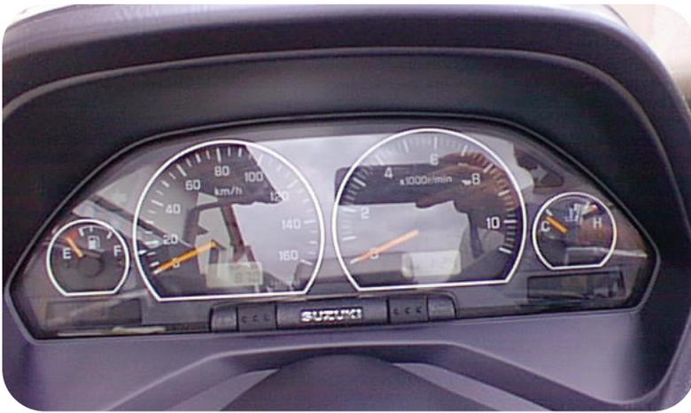
Tankuhr, Tacho, Drehzahlmesser, Temperaturanzeige, Kilometerzähler mit 2 x Tageskilometer, Digitaluhr und Kontrolleuchten
