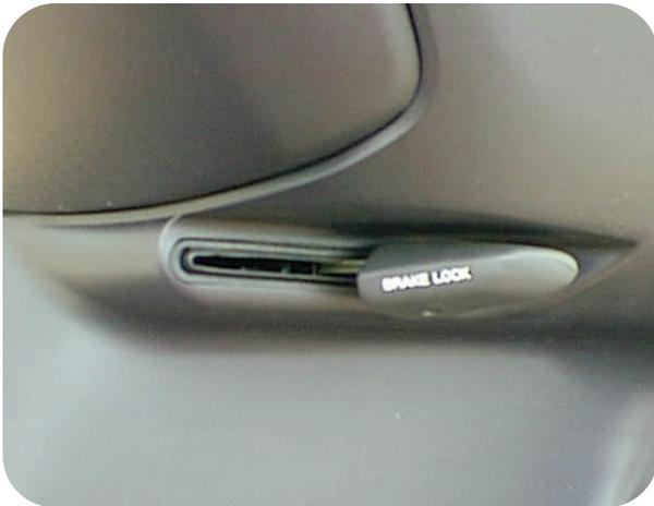
Handbremshebel ist links unter dem Handschuhfach
