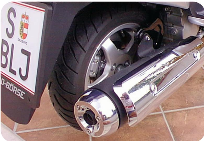
Auspufftopf mit verchromter Abdeckung, Hinterradfelge ist über Lochkreis an den Antrieb befestigt - rascher Ausbau des Rades möglich!
