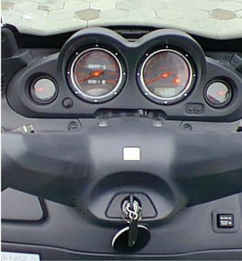
Die Rundinstrumente, Tankanzeige, Tachometer mit Kilometer- und Tageskilometerzähler, Drehzahlmesser mit Digitaluhr, Temperaturanzeige für Kühler, sind gut ablesbar. Es gibt eine Anzeigeleuchte für Handbremse, Fernlicht und je eine für den rechten u. linken Blinker. Leider keine für den Seitenständer! Der Handbremshebel sitzt rechts im Armaturenbrett und wirkt über Seilzug auf das Vorderrad. Ist sehr einfach zu bedienen! Daneben ist der Leerlauf-Motorstop-Schalter.
