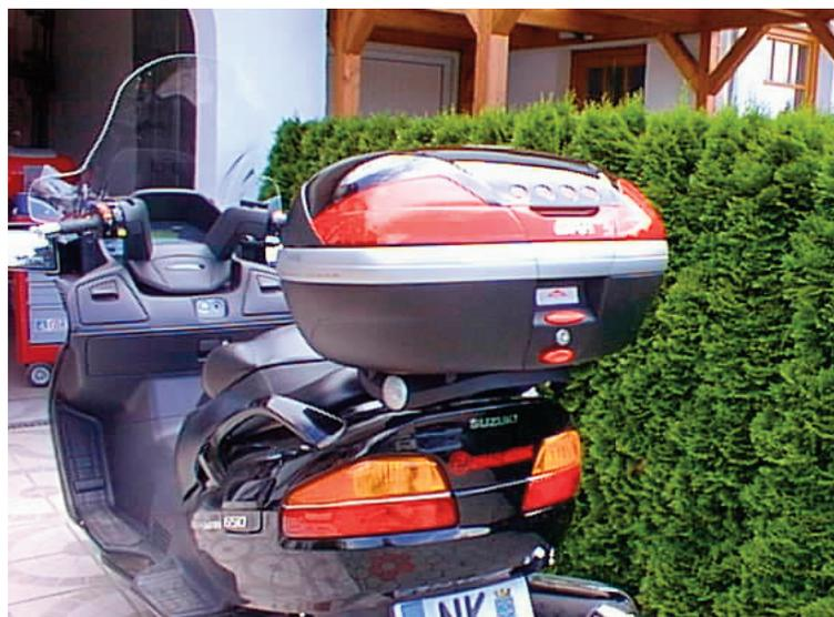
Koffer V46N902 von Givi mit einbegautem Bremslicht und Innenbeleuchtung E106
