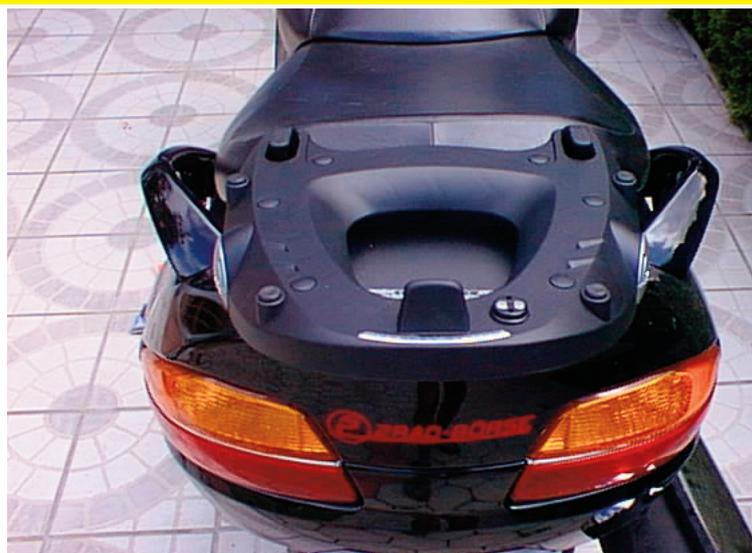
Topcaseträger E529 von Givi mit Kontakte für Bremslicht E105
